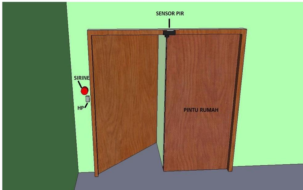
Rangkaian Sensor PIR, Rangkaian Sirine dan Handphone diletakkan di balik pintu rumah.
