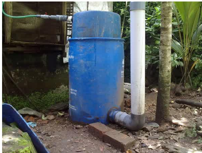
Gambar 2. Contoh reaktor biogas skala rumah tangga.
