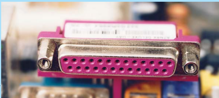
Parallel port masih tersedia pada sebagian besar mainboard masa kini. Nantinya, semuanya akan digusur habis oleh USB.
