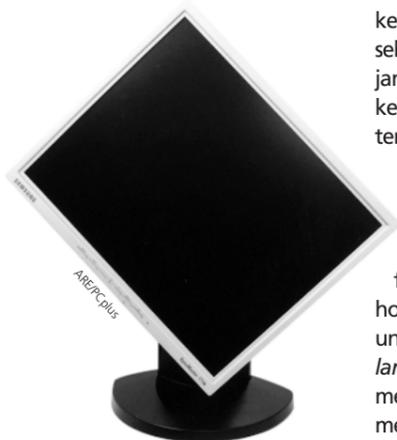
salah satu di antaranya adalah Samsung SyncMaster 171N. Monitor ini memiliki resolusi 1280 x 1024 pada 75Hz. Tetapi, tidak seperti monitor LCD terbaru, Samsung SyncMaster 171N ini tidak dilengkapi *input* DVI. Tipe *input* VGA yang digunakan untuk terhubung dengan kartu grafis adalah melalui *port* Analog 15 pin D-Sub biasa.
