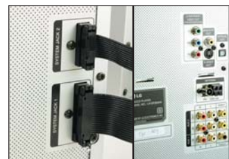
▲MIRIP PC. Lihat, konektornya hampir menyerupai kabel IDE untuk hard disk PC.
