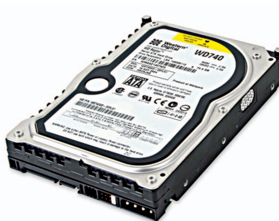
Harddisk ber-interface SATA dengan kecepatan spindle 10.000 rpm.
