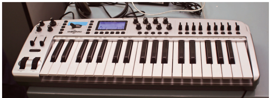
Perangkat pembuatan sound effect dan musik ilustrasi yang mobile . Perangkat ini hanya bisa bekerja dengan PC atau notebook, kecuali jika ditambah dengan modul stand alone .
