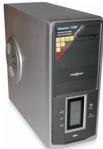
Selain LCD, casing ini juga mempunyai CPU intake, fan pendingin khusus untuk CPU pada side panel.
